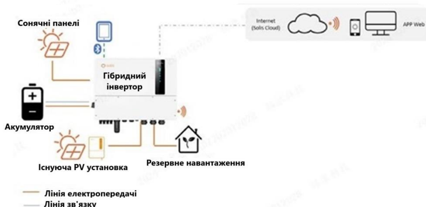
Малюнок 3.5 Типова схема з підключенням до мережі змінного струму (поза мережею)
